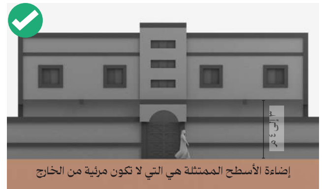
الشكل ٣٠: لا يُسمح بأن تكون الإضاءة مرئية من حدود السطح والحائط الحدودي
